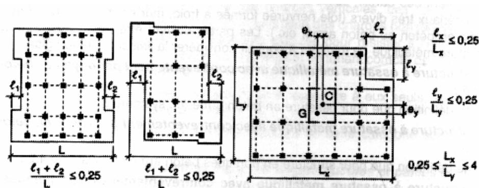
**Fig. 3.2 : Limites des décrochements en plan**
