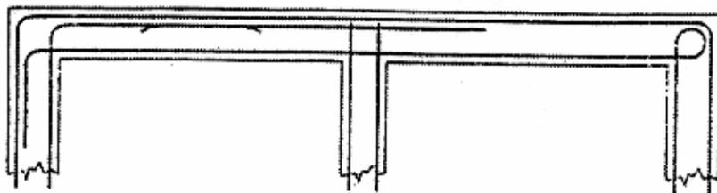
Fig. 9.2 Dispositions typiques des chaînages en plan
