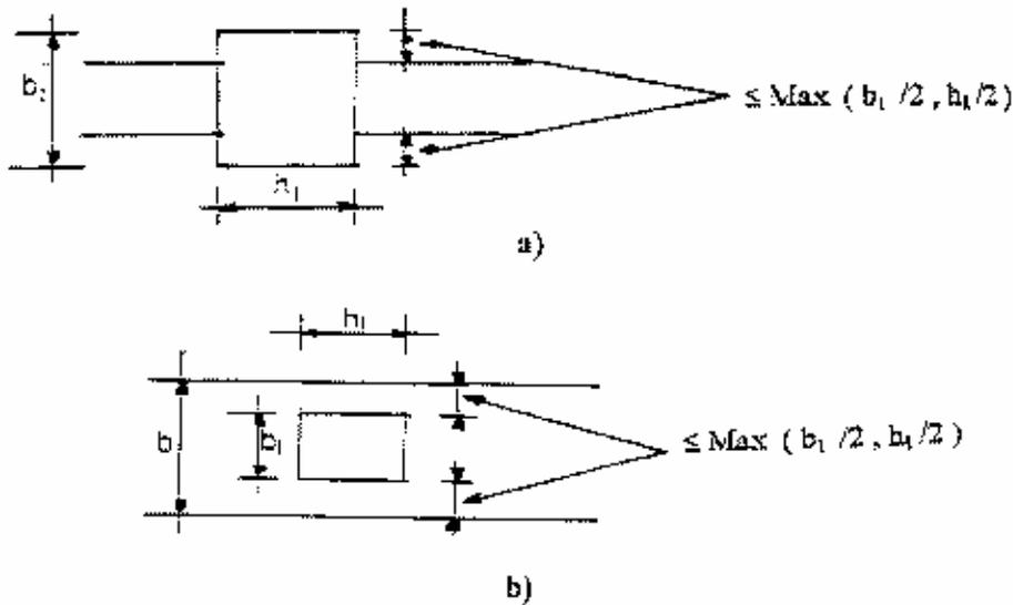
Fig 7.4 : Dimensions à respecter par les poutres
