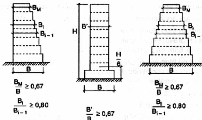
**Fig. 3.2 : Limites des décrochements en élévation**
