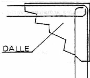
Fig. 7.14 : chaînages des dalles et des diaphragmes
