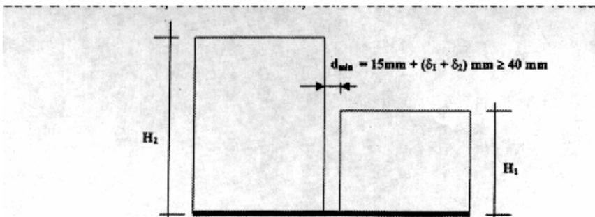
**Figure 5.1 : largeur minimum du joint sismique**
