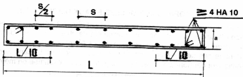
Fig. 7.13 : Disposition des armatures verticales dans les voiles
